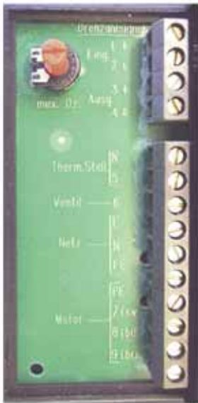
Potentiometer A Drehzahl-Maximalbegrenzung
